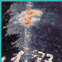
Non revêtu de zinc : les dommages se sont aggravés et la corrosion (marques rouges) s'étend au-delà de l'entaille
